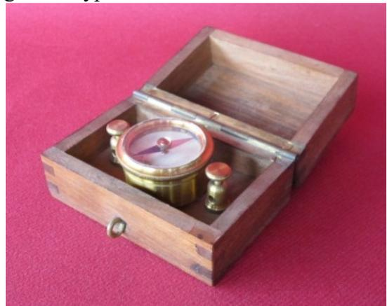
Et puis il y a le fameux galvanomètre à miroir de Lord Kelvin (Thomson). Il servait à mesurer des courants très faible aux laboratoires et salles de test, mais pouvait également être utiliser pour capter les signaux extrêmement faibles des câbles sous-marin intercontinentales .
